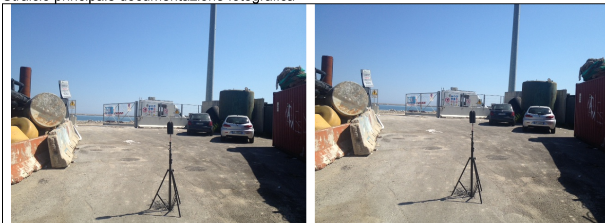
Figura 5.3 – Posizionamento della strumentazione impiegata nel punto R01 (campagna di giugno)
