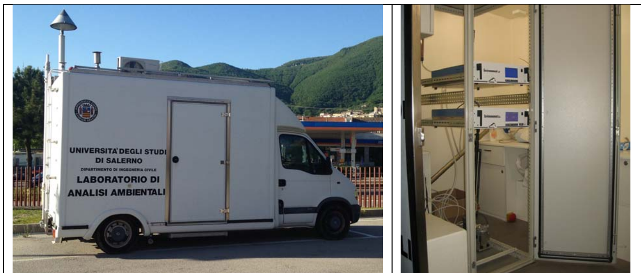
Figura 3.3 – Analizzatori installati all'interno del Laboratorio Mobile del Dipartimento di Ingegneria Civile dell'Università di Salerno
