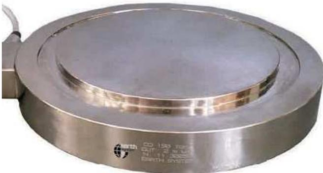
La cella di carico tipo è costituita da un corpo in acciaio inossidabile sensibilizzato da una serie di griglie estensimetriche (strain-gauges) applicate alla superficie interna del corpo stesso e isolate.
