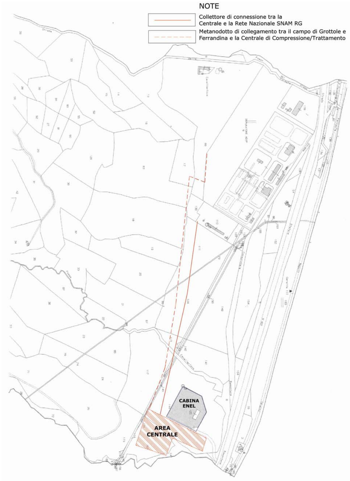
fig. 4 : Collettore di connessione tra la Centrale e la Rete Nazionale alta pressione SNAM RG e metanodotto di collegamento tra il campo e la Centrale
