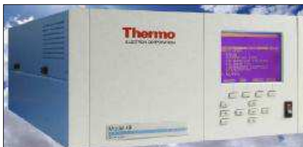
Analizzatore del CO, mod. Thermo Electron 48i.
