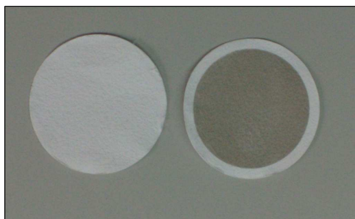
Filtro bianco e filtro dopo il campionamento delle polveri mediante metodo gravimetrico.
