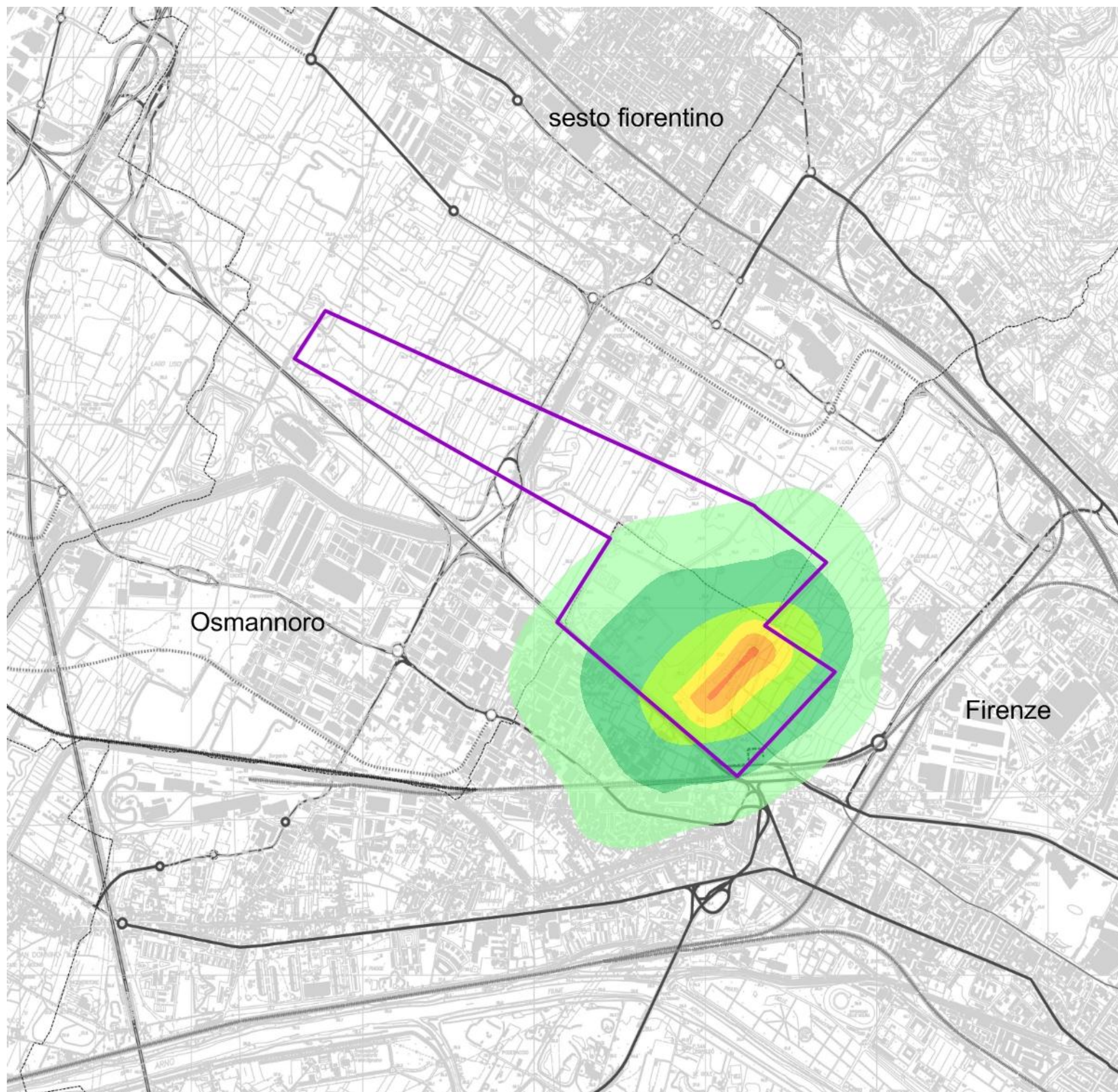
Tavola 9 – Concentrazioni medie annuali di PM 10 per le emissioni della sola aerostazione
