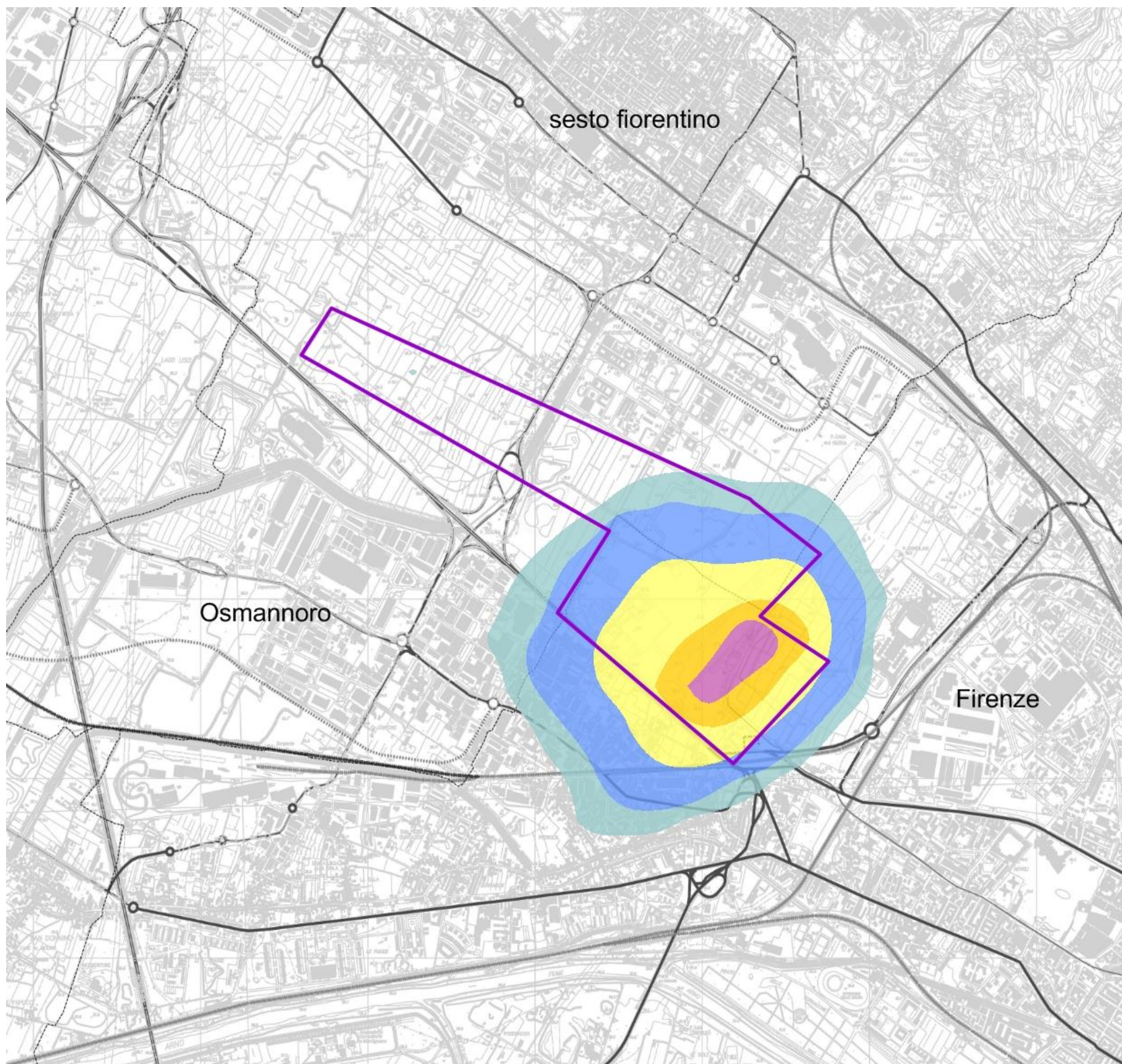
Tavola 17 – Concentrazioni medie annuali di NO 2 per le emissioni totali delle sorgenti aeroportuali
