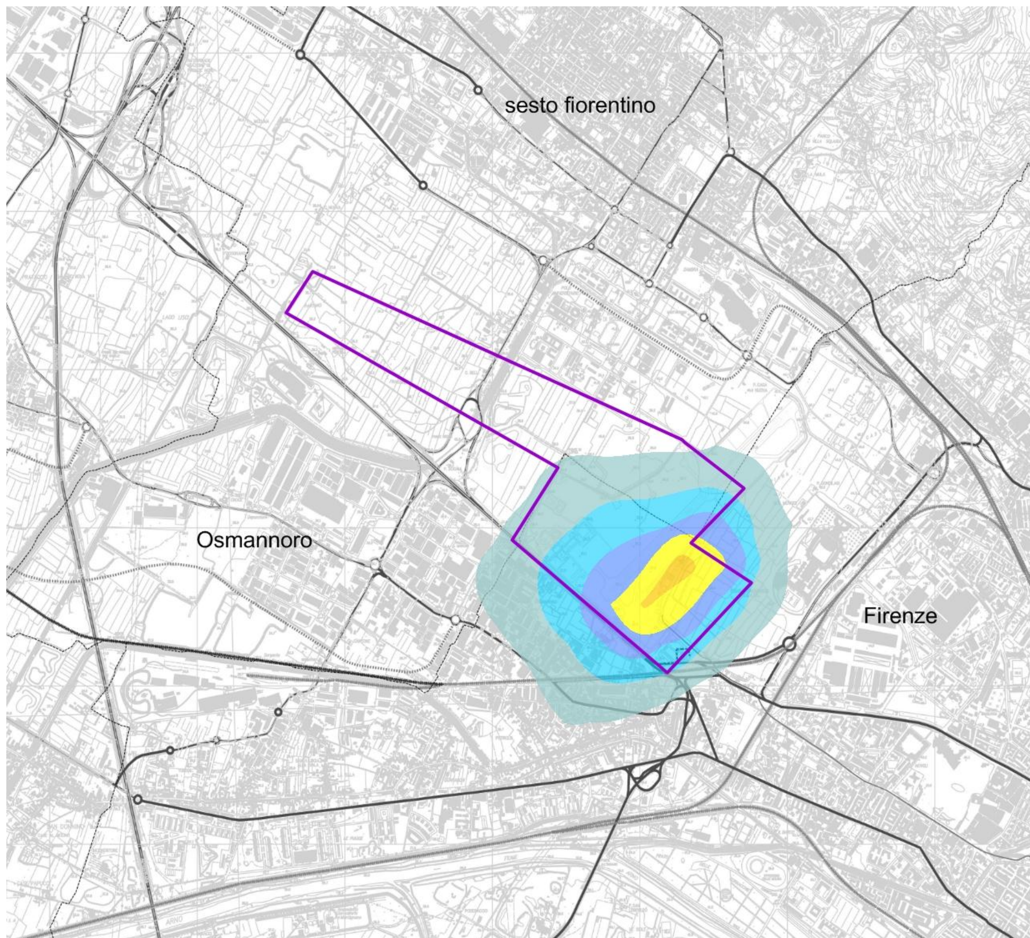
Tavola 33 – Concentrazioni medie annuali di BENZENE per le emissioni della sola aerostazione
