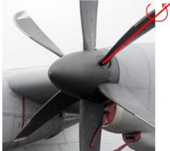
Figura 7. Meccanismo di thrust reverse in turboelica
