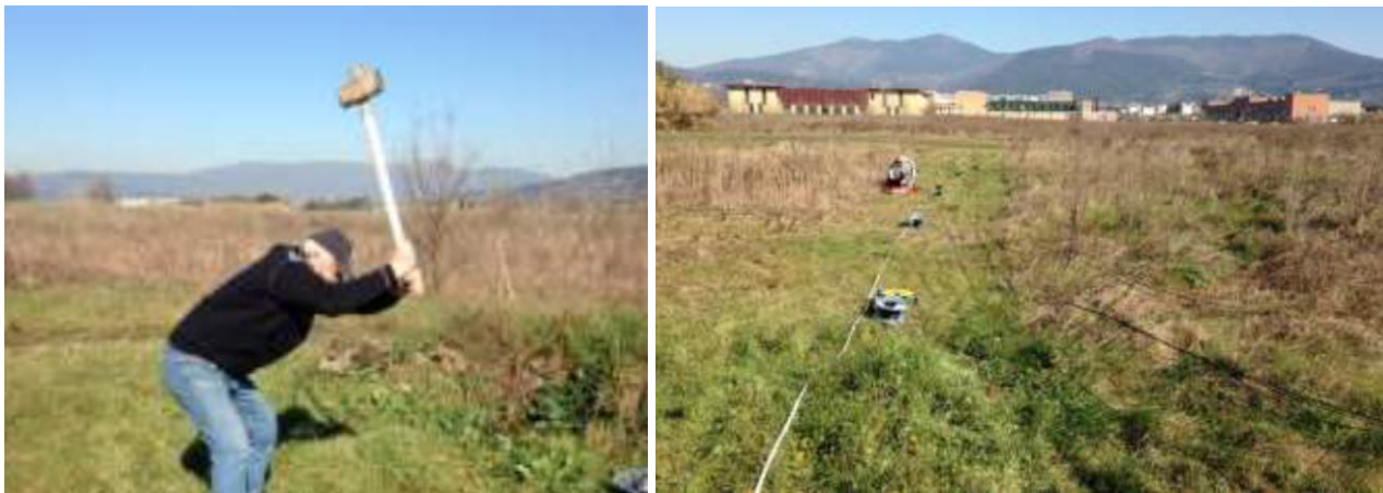
Figura 21. Attività di energizzazione del terreno e rilevamento dei segnali di vibrazione
