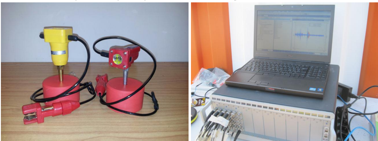
Figura 13. Geofoni/velocimetri e centralina di acquisizione
