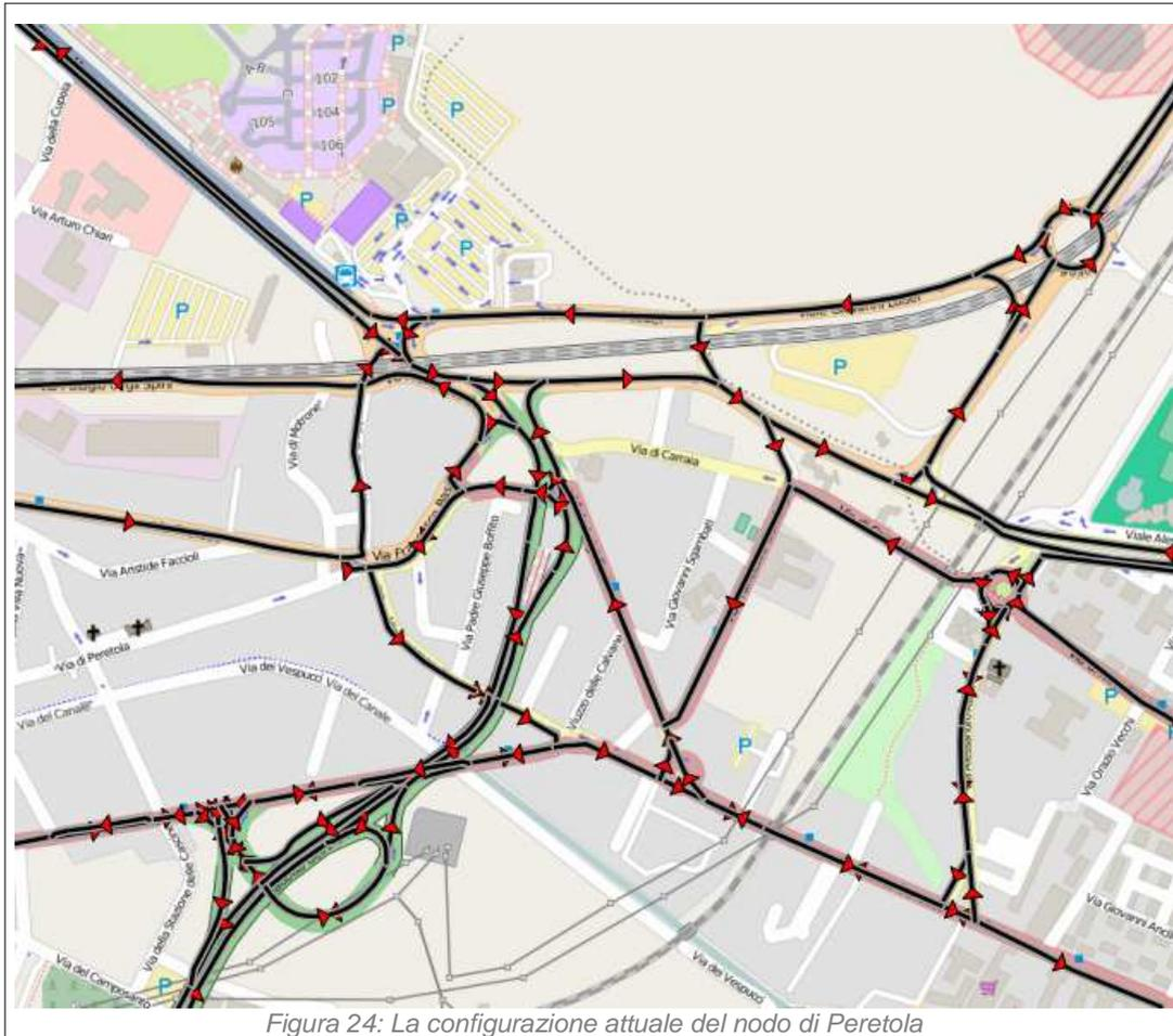
Gli archi del raccordo autostradale dell'A11 sono caratterizzati da 2 corsie per carreggiata per un totale di capacità a saturazione di 3400 veicoli/ora.
