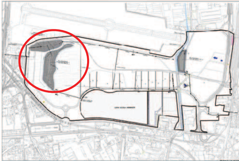
Fig. 20 – Planimetria delle sistemazioni idrauliche dell'area PUE di Castello – In evidenza le casse di espansione per la regimazione e compensazione idraulica dell'intervento
