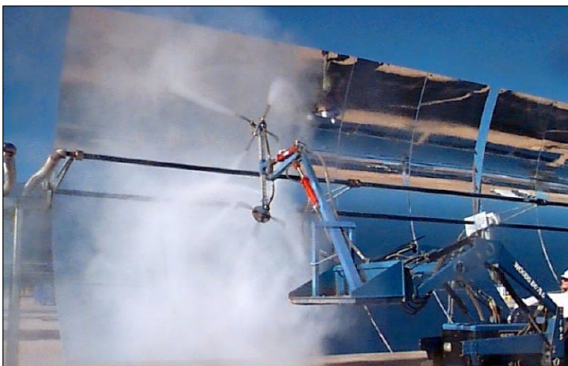
Figura 34: Sistema di pulizia specchi ad alta pressione Voith
