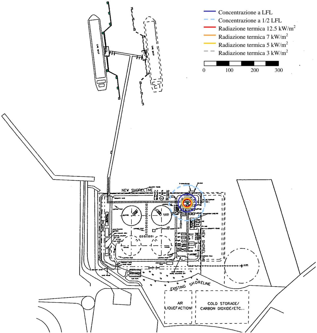
Allegato 1.C.9: Scenario 4 – Rilascio di Vapori Dalle tubazioni per il controllo dei Gas di Evaporazione
