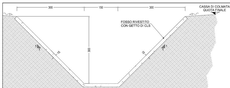
Figura 9.24: Area 8 - Sezione tipologica fosso di raccolta
