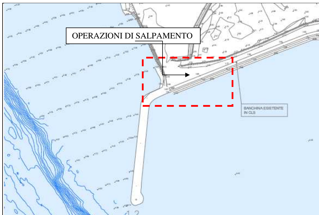
Figura 3.7: Area 1 – Area soggetta a salpamento opera a gettata esistente
