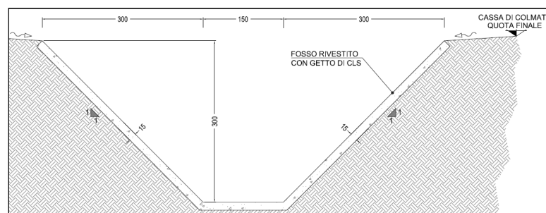
Figura 3.34: Area 10 - Sezione tipologica fosso di raccolta
