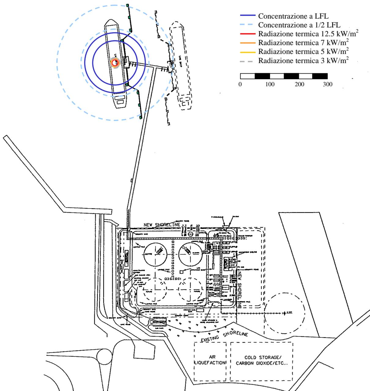
Allegato 1.C.15: Scenario 10 – Perdita di GNL sul Ponte della Nave Gasiera
