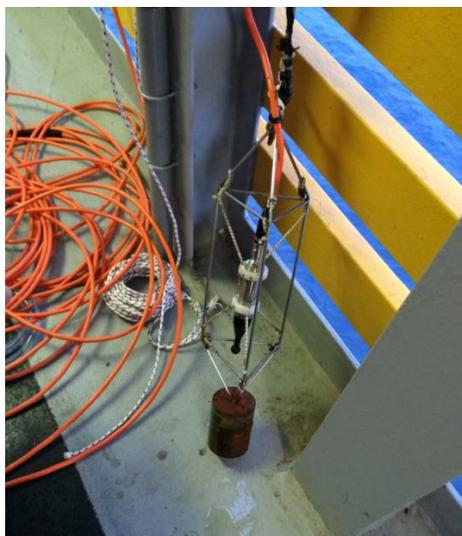
**Fig. 2.2.2.2.3 Idrofono con gabbia di protezione**
