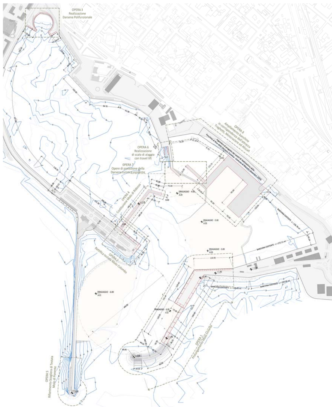
Figura 4 - Planimetria delle opere marittime del porto di Marsala – futuro PRP.
