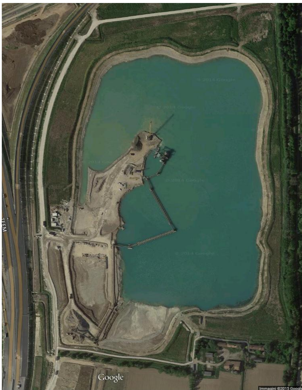
Fig. 5 – Ortofoto dell’area di cava. Evidenti i nastri trasportatori che dalla draga raggiungono le aree di accumulo (da Google Maps)
