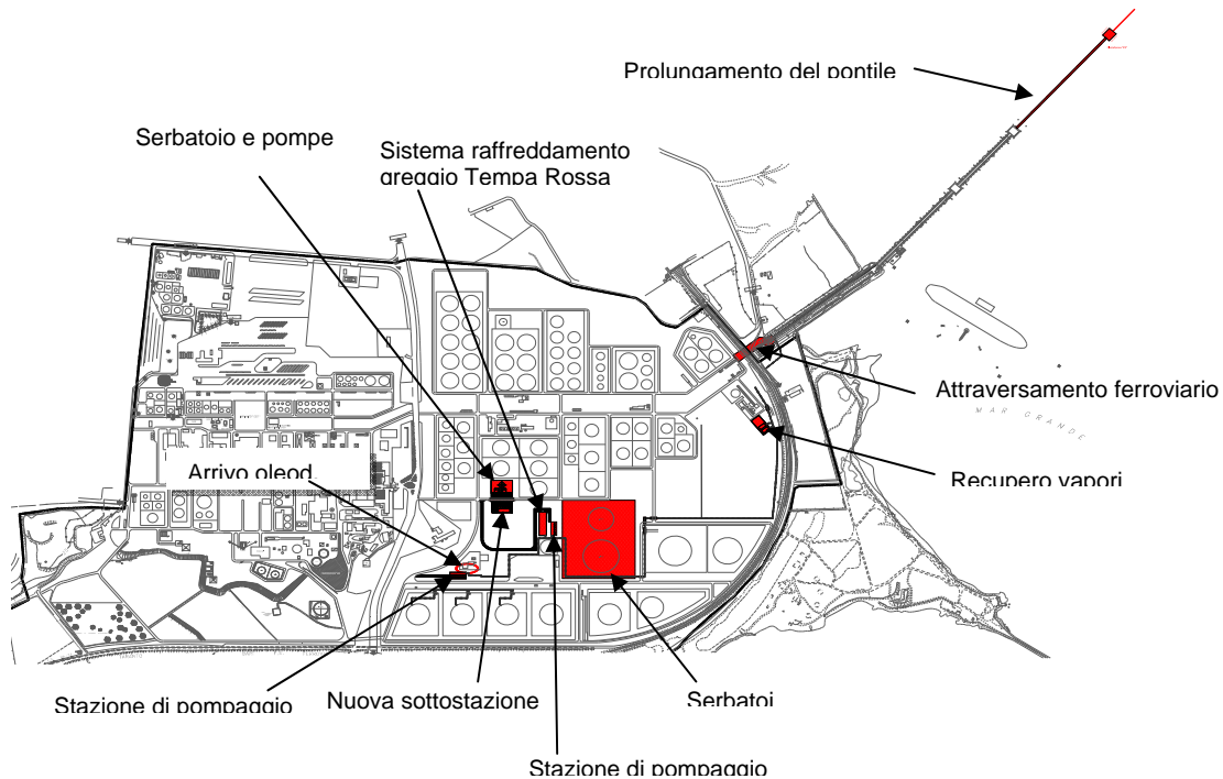
Figura 6 – Interventi di progetto: realizzazione in rosso
