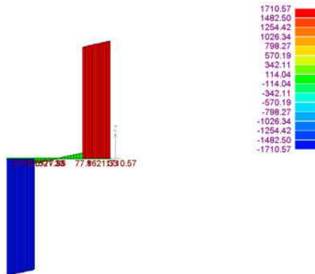
Figura 29 Figura 30 Sollecitazioni taglianti trave tipo B ( T_{max}=1710,57\text{kN} )
