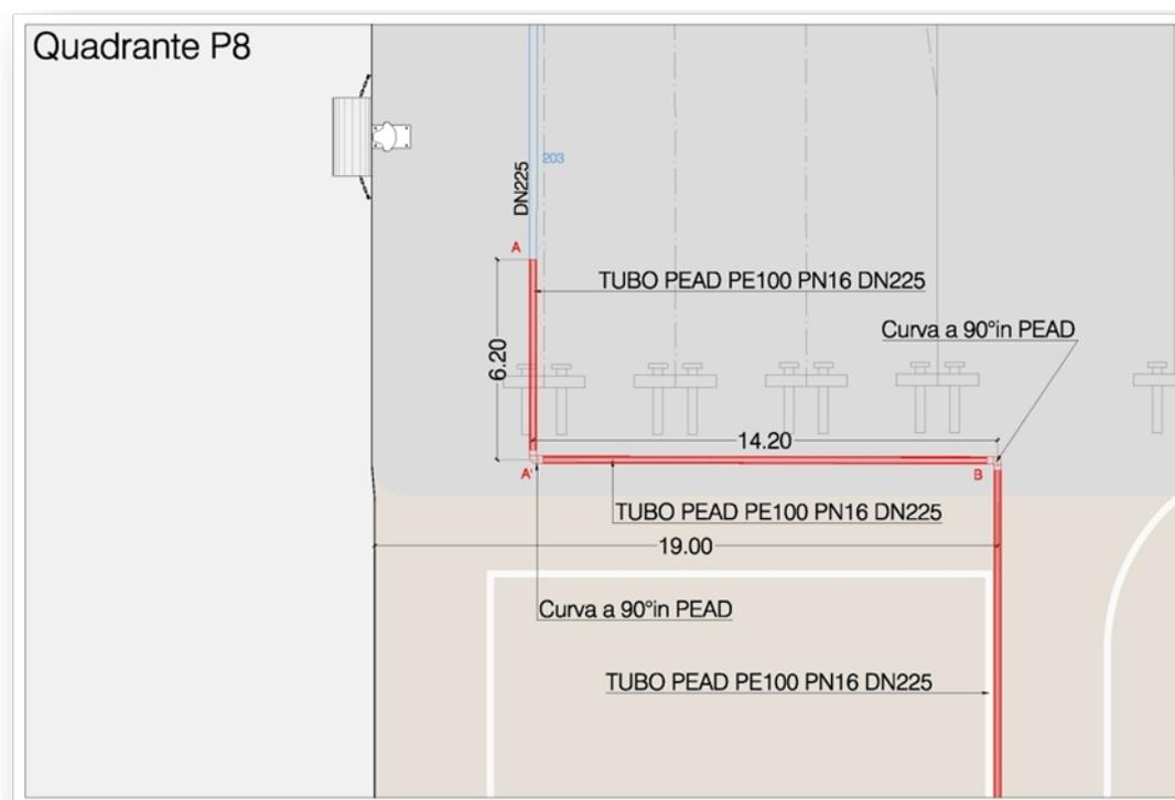
Figura 4 Superamento interferenza banchina Nord
