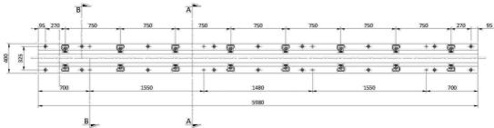
No 300 Piattabande mm 5980x400x20 come da nostro disegno n. NRAA.1189 e a venti le seguenti caratteristiche tecniche:
