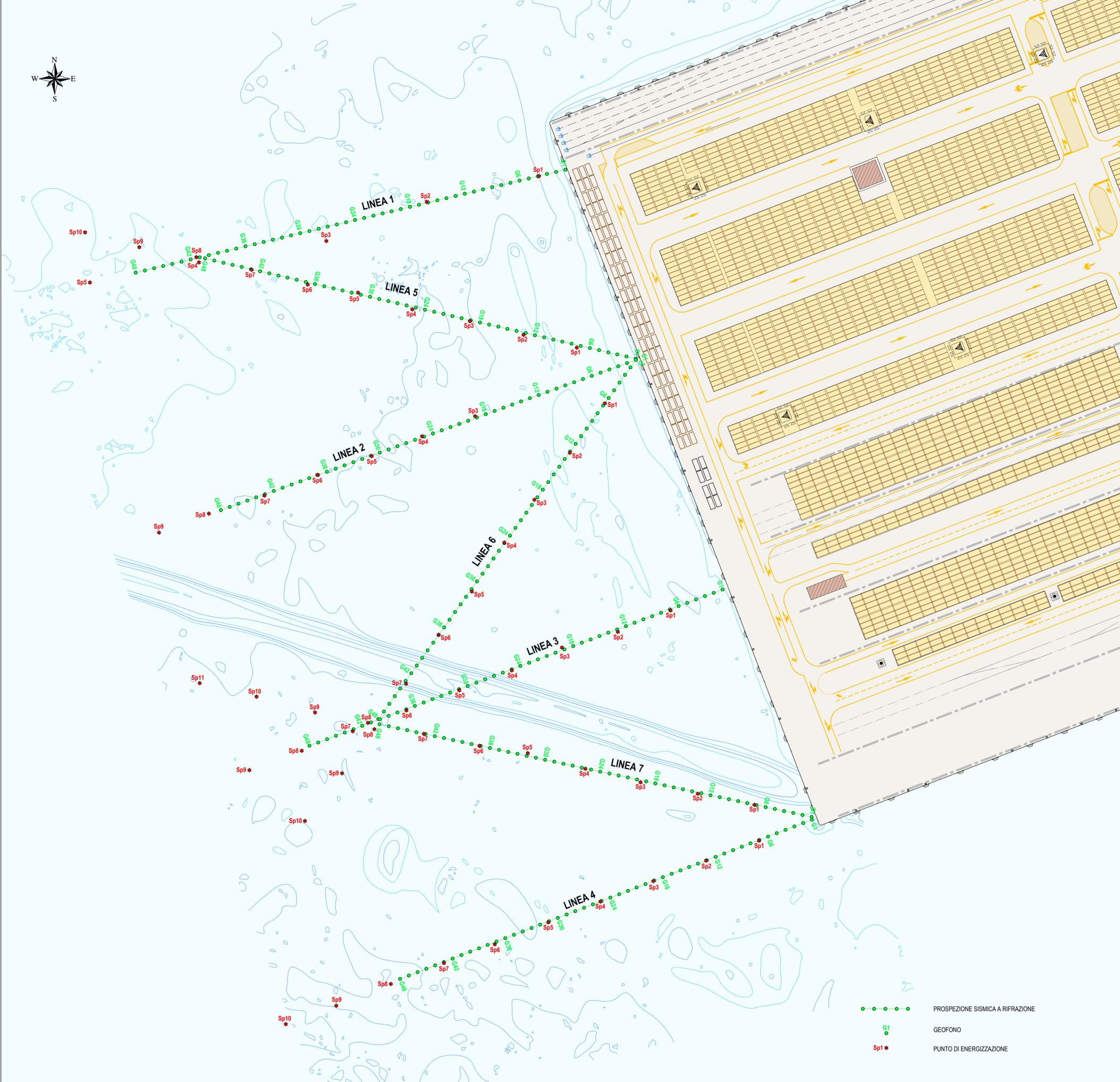
PROSPERAZIONE SISMICA A RIFRAZIONE
