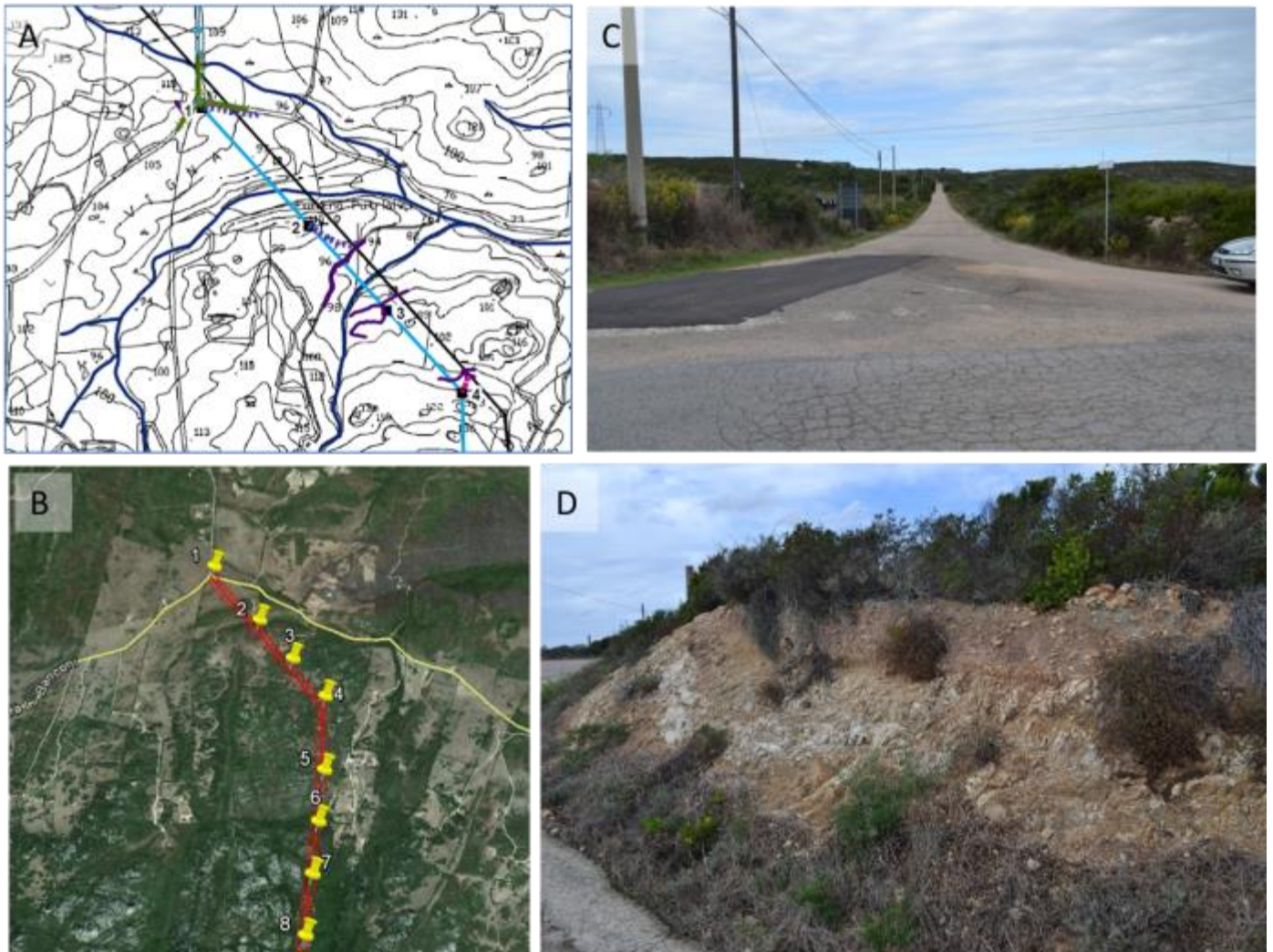
Figura 10-2: A) Ubicazione dello Stop 2 nella CTR; B) Ubicazione su Google Earth, in rosso è sempre indicato il tracciato dell'elettrodotto e i cavi aerei; C) Foto dell'inizio della Strada Li Cumandanti Saltara, in cui ha inizio il tratto del cavo interrato; D) Affioramento roccia granitica alterata e pedogenizzata.
