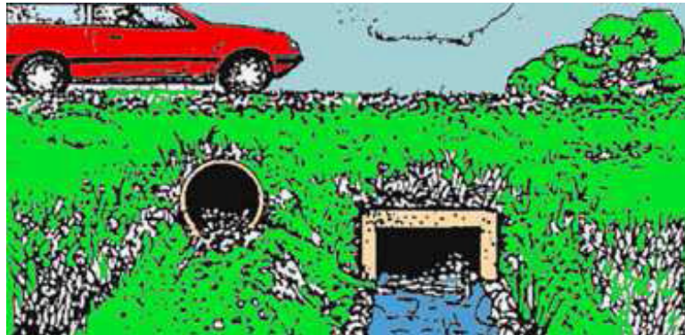
Figura 5.1 - Esempi di cunicoli per attraversamento animali
