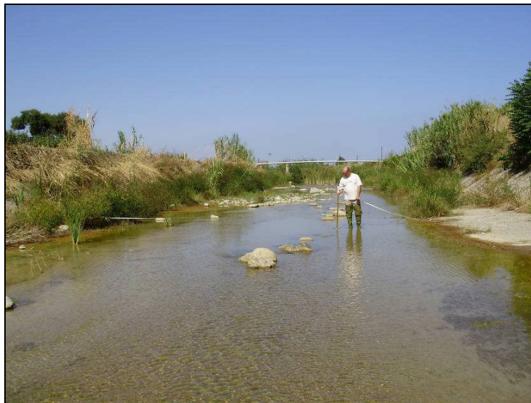
Foto 2 – Misura di portata sul Torrente Pantanello nella stazione ST_3 (Fonte: Laserlab, 2012)
