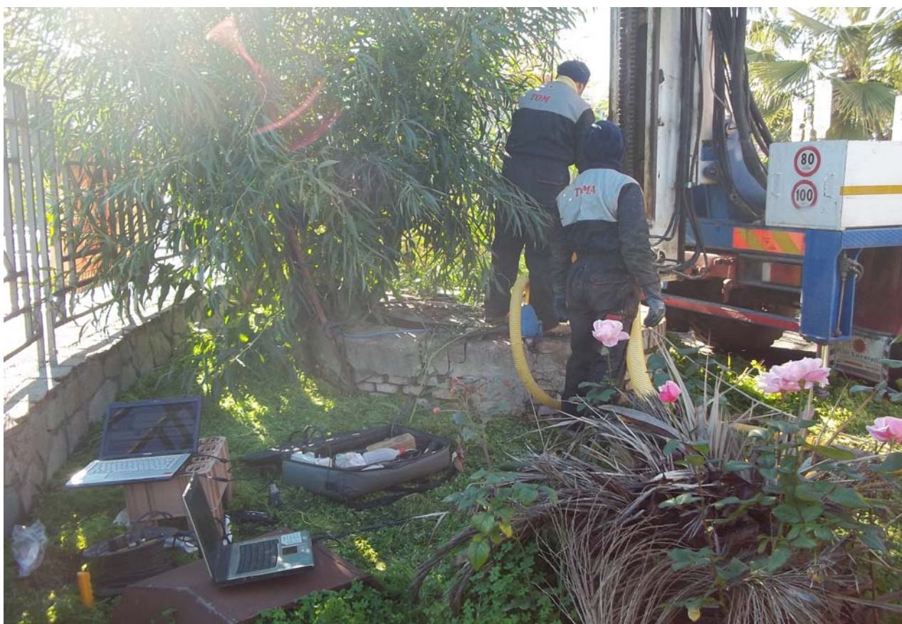
TEST IDRAULICO POZZO P5
