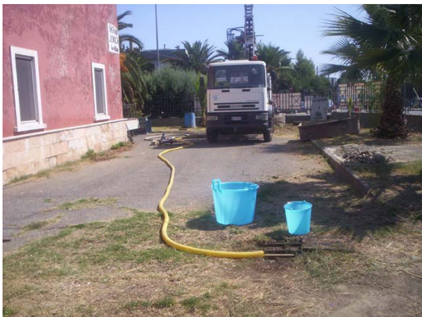
Fig.6) Particolare contenitori tarati per misurazioni periodiche di portata – Pozzo5
