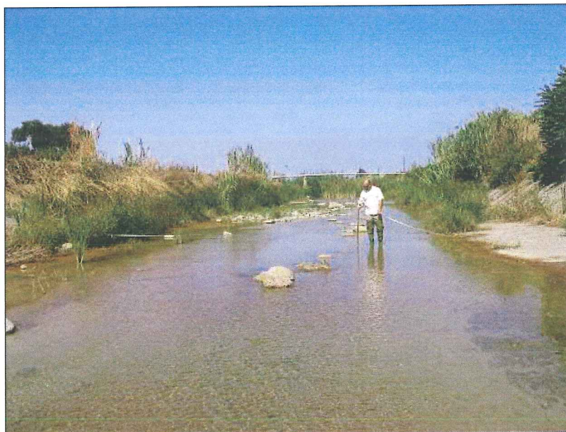
Foto 2 – Misura di portata sul Torrente Pantanello nella stazione ST_3 (Fonte: Laserlab, 2012)
