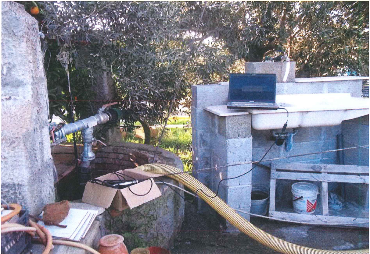
TEST IDRAULICO POZZO P2
