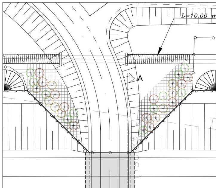
Figura 57-1 Pianta varco faunistico prog. 7+244
