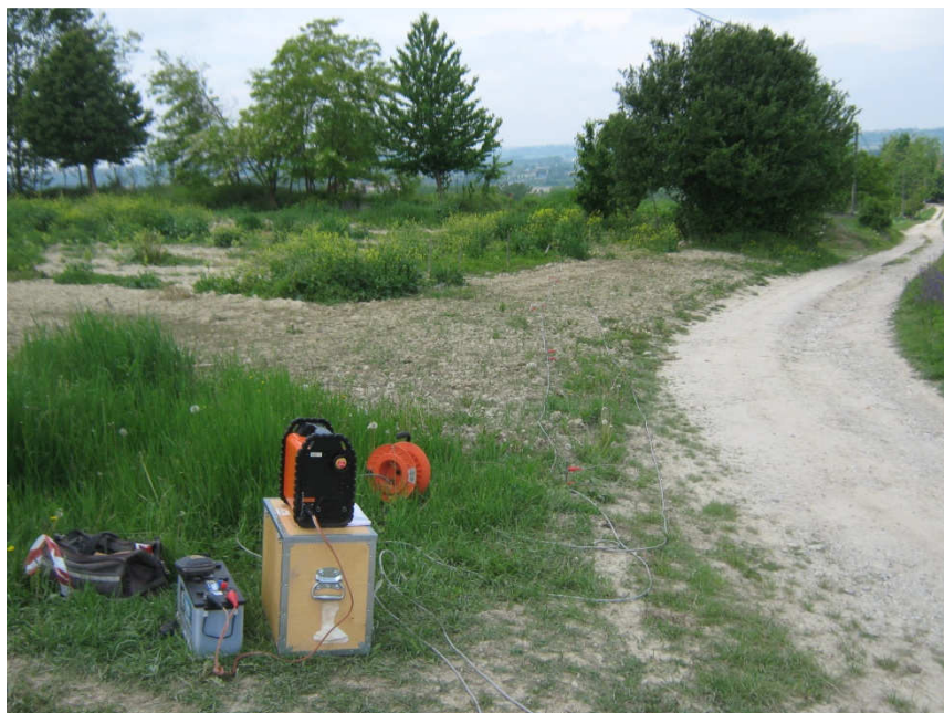
Unità d'acquisizione ABEM Terrameter LS.
