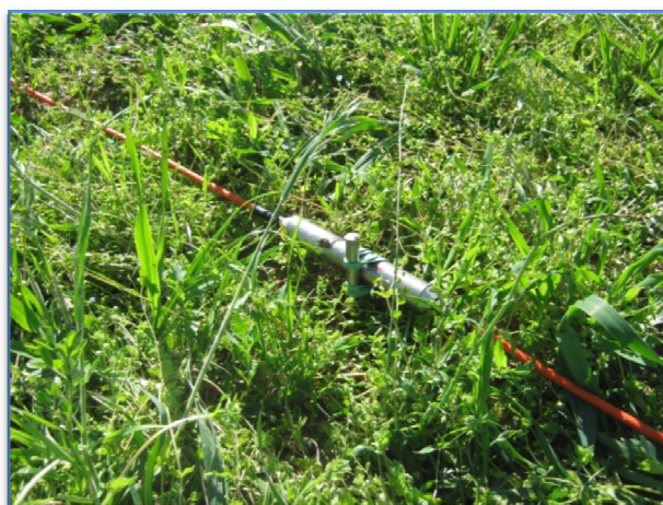
Elettrodo collegato ad un picchetto in ottone
