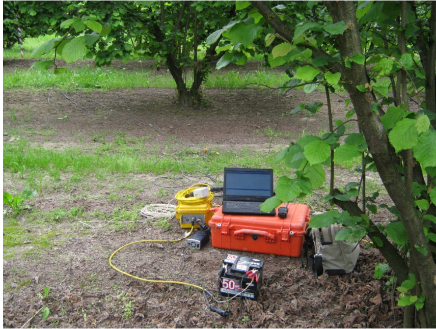
Indagine sismica a riflessione (profilo di rilievo E).
