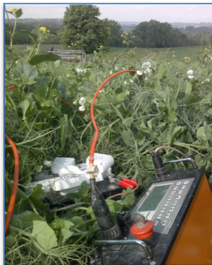
Georesistivometro multielettrodo ARES 200E con elettrodi attivi.
