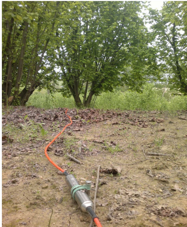
Stendimento linea elettrica profilo di rilievo A; elettrodi attivi.
