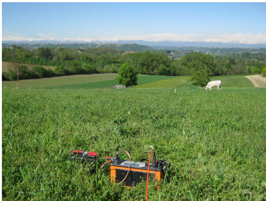
Unità d'acquisizione ARES 200E.
