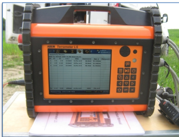
Georesistivometro multielettrodo ABEM Terrameter LS con elettrodi passivi.
