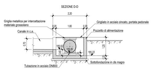
POZZETTO DI SCARICO
