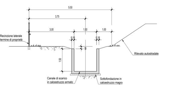
**Sezione trasversale tipo in presenza di fosso al piede rilevato e canale di scarico (H=1.50 m) Sez. tipo 3**
