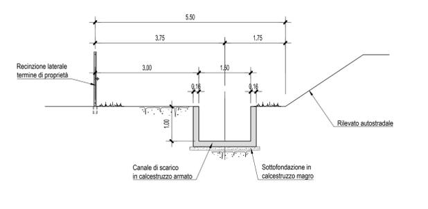
**Sezione trasversale tipo in presenza di canale di scarico (H=1.50 m) al piede rilevato Sez. tipo 2**
