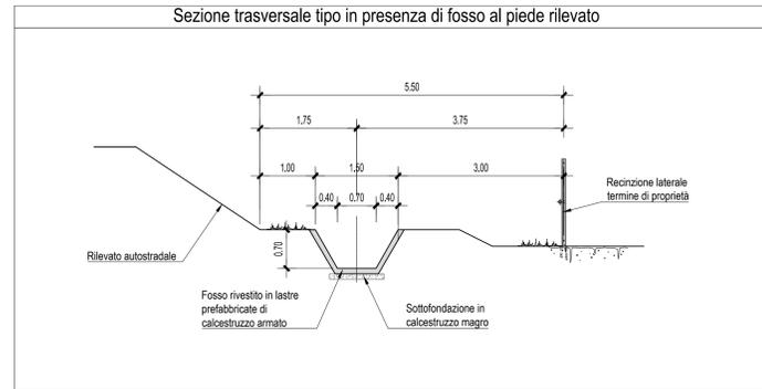
**Sezione trasversale tipo in presenza di canale di scarico (H = 1.00 m) al piede rilevato Sez. tipo 1**
