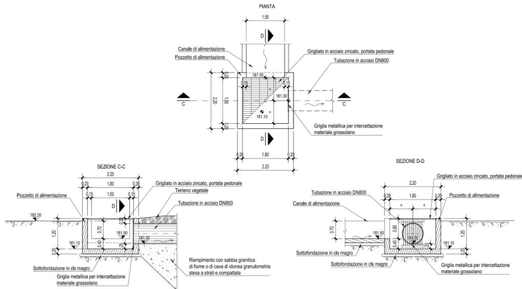
POZZETTO DI SCARICO
