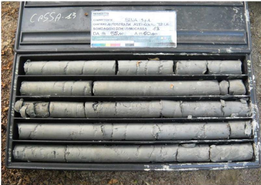
Figura 9.10 – Sondaggio IOM-MO-060: esempio di marna (unità 7)
