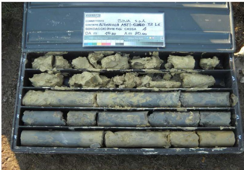
Figura 9.8 – Sondaggio IOV-VE-046: esempio di argilla marnosa tra m 17 e m 20 (depositi pliocenici) (unità 5)
