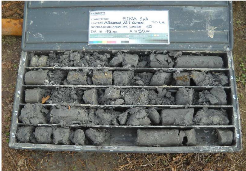
Figura 9.6 – Sondaggio SOT-VE-025: esempio di lenti sabbiose all'interno del substrato marnoso (unità 3 e 7a)
