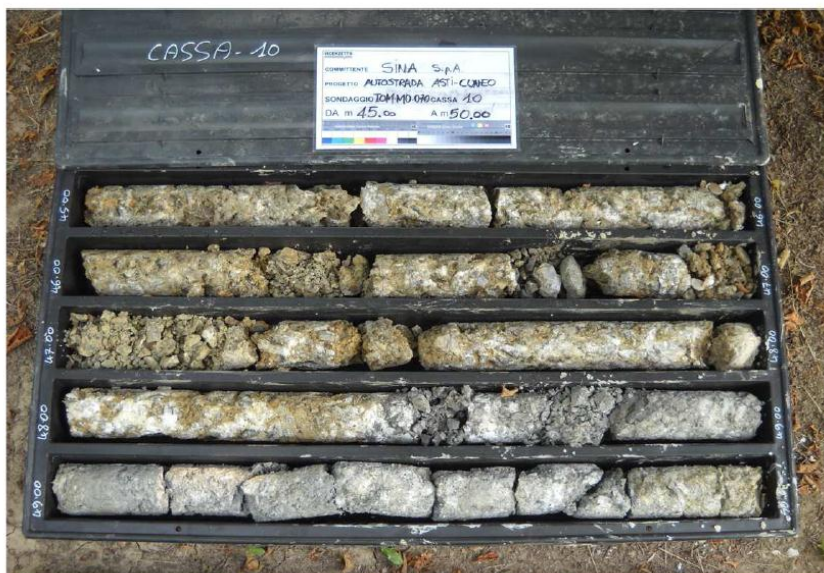
Figura 9.9 – Sondaggio IOM-MO-070: esempio di roccia gessifera (unità 6)
