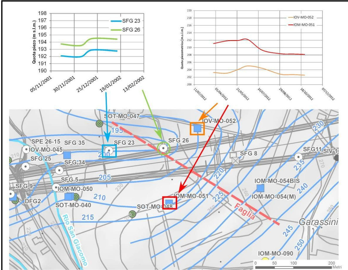
Figura 30. Confronto dell'evoluzione piezometrica tra piezometri selezionati sui due lati della presunta faglia.
