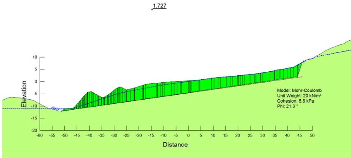
**Figura 9.5: Cascina dello Spià –Analisi di stabilità nelle condizioni attuali “ante operam” – Superficie di scivolamento critica e grado di sicurezza  $\gamma_R$  per la sezione rappresentativa -a- (AT-15bis/AT-16 di progetto), parte meno acclive del versante**
