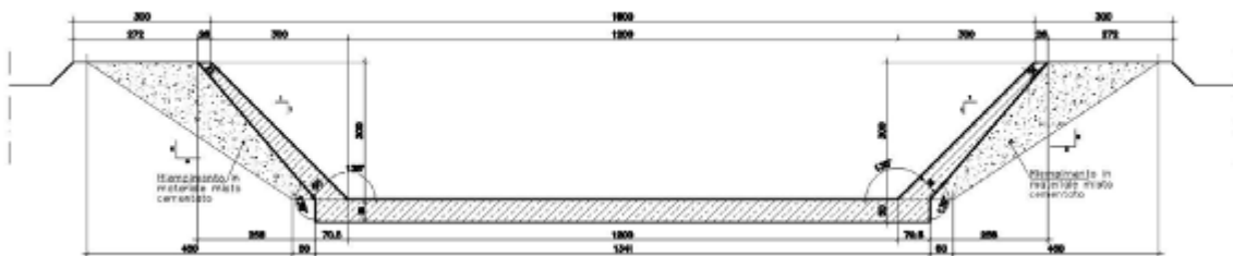
Figura 2-5: Sezione tipo del canale
