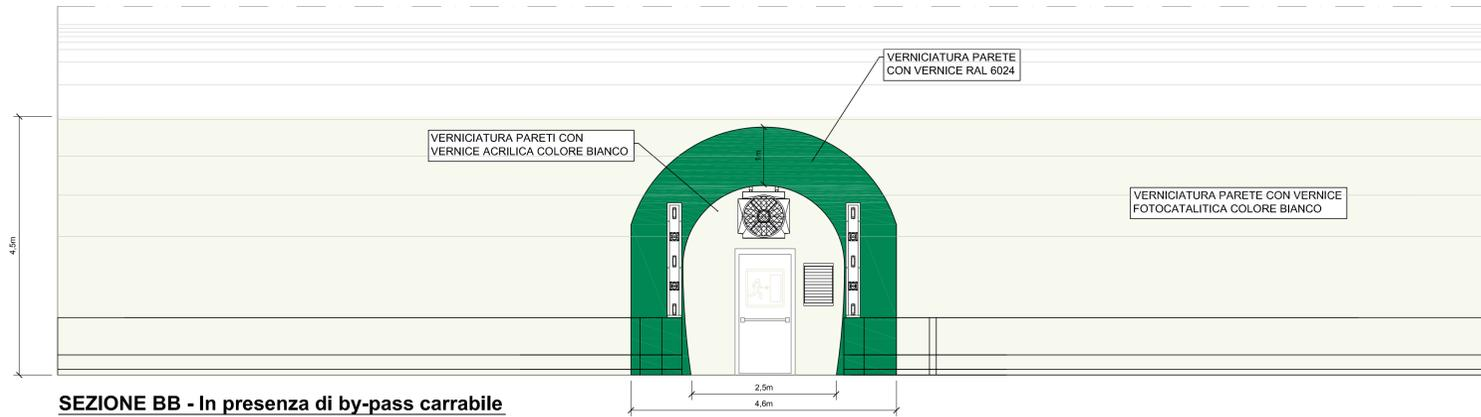
**SEZIONE BB - In presenza di by-pass carrabile**
