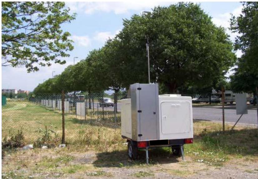
Foto 1: Stazione di monitoraggio su carrello mobile.
