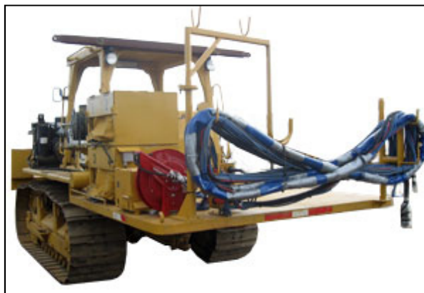
Figura 6-9: Trattore tipo pay-welder per la generazione di corrente in cantiere
