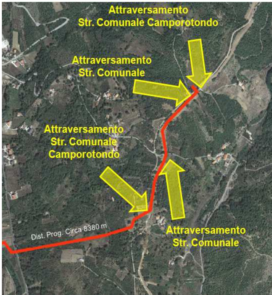
Figura 4-10: Sesto Tratto (fino alla Distanza Progressiva di circa 8.380 m). Individuazione degli Attraversamenti Stradali
