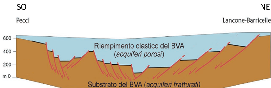
Figura 1-23: geometria sepolta del bacino dell’Alta Val d’Agri e sua profondità massima (da Colella, Rizzo, Lapenna, 2003).
