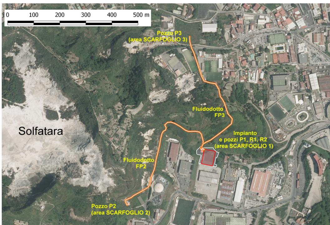
Figura 4-2 e Figura 4-3 – Ubicazione a macroscala e scala locale dell'impianto pilota "Scarfoglio"
