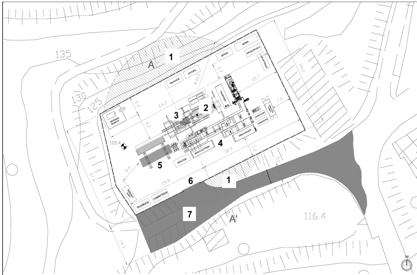
Figura 4-19 Layout piazzola di perforazione SCARFOGLIO 2
