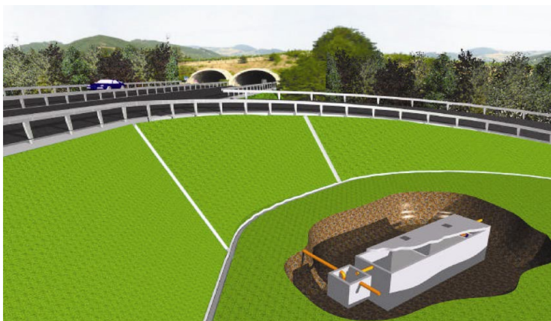
Rappresentazione schematica della localizzazione di un impianto per il trattamento delle acque di prima pioggia
