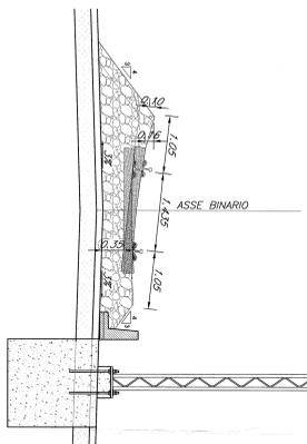
SEZIONE TIPO IN RILEVATO A SINGOLO BINARIO - TIPO 9
