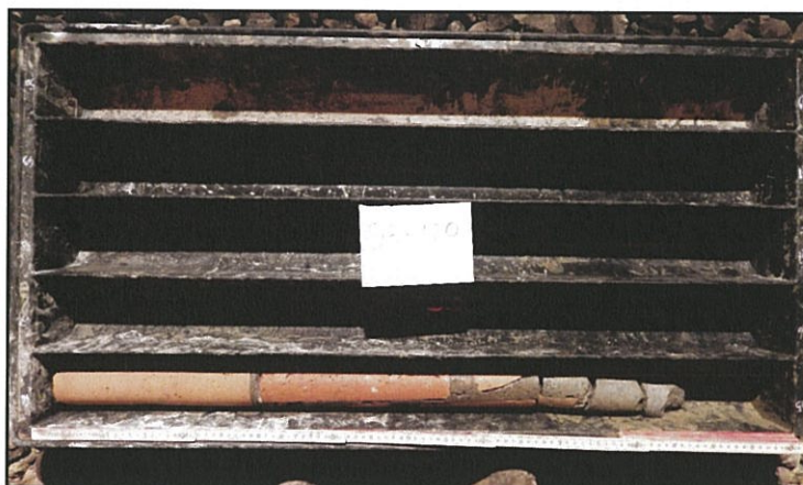
Foto 3: Casseta catalogatrice contenente gli spezzoni di carota estratti dal foro (si distingue il passaggio rivestimento/roccia a tergo della muratura)
