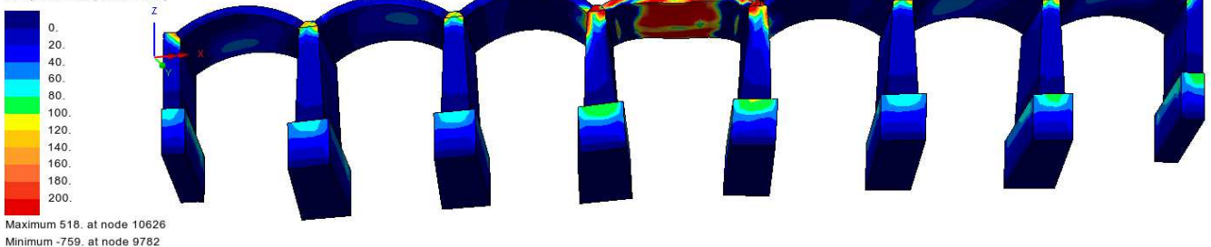
Figura 54: mappa tensioni S1: peso proprio x 1.35 + treno x \alpha_{ult}
