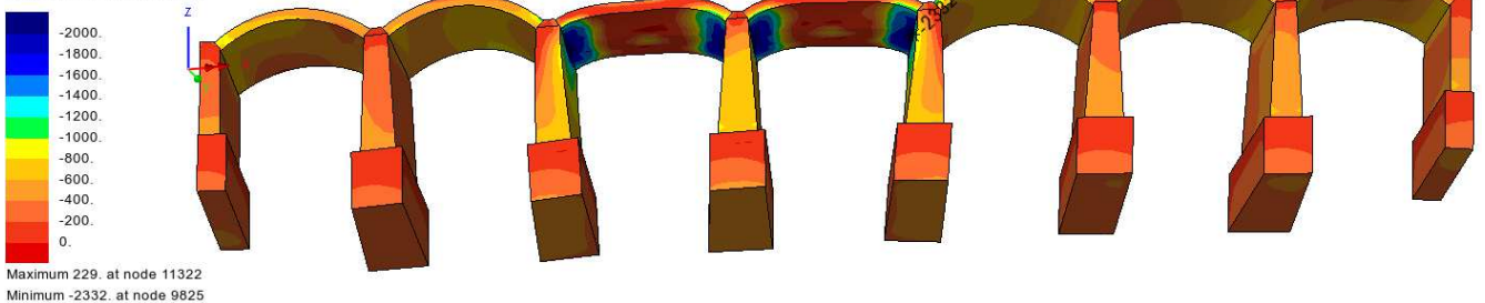
Figura 78: mappa tensioni S3: peso proprio x 1.35 + treno x \alpha_{ult}
