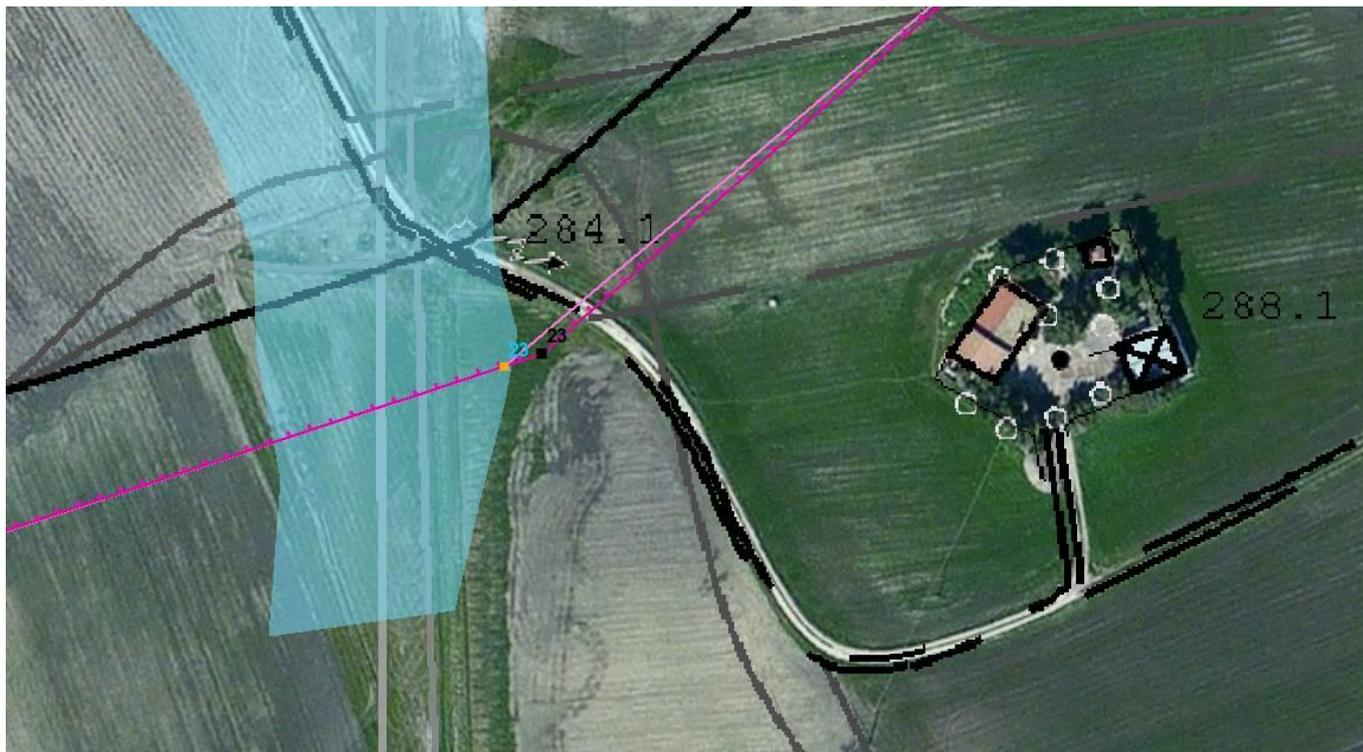
Figura 10 - Il sostegno 23 è stato posizionato fuori dalle aree a media pericolosità idraulica Tr 200 anni
