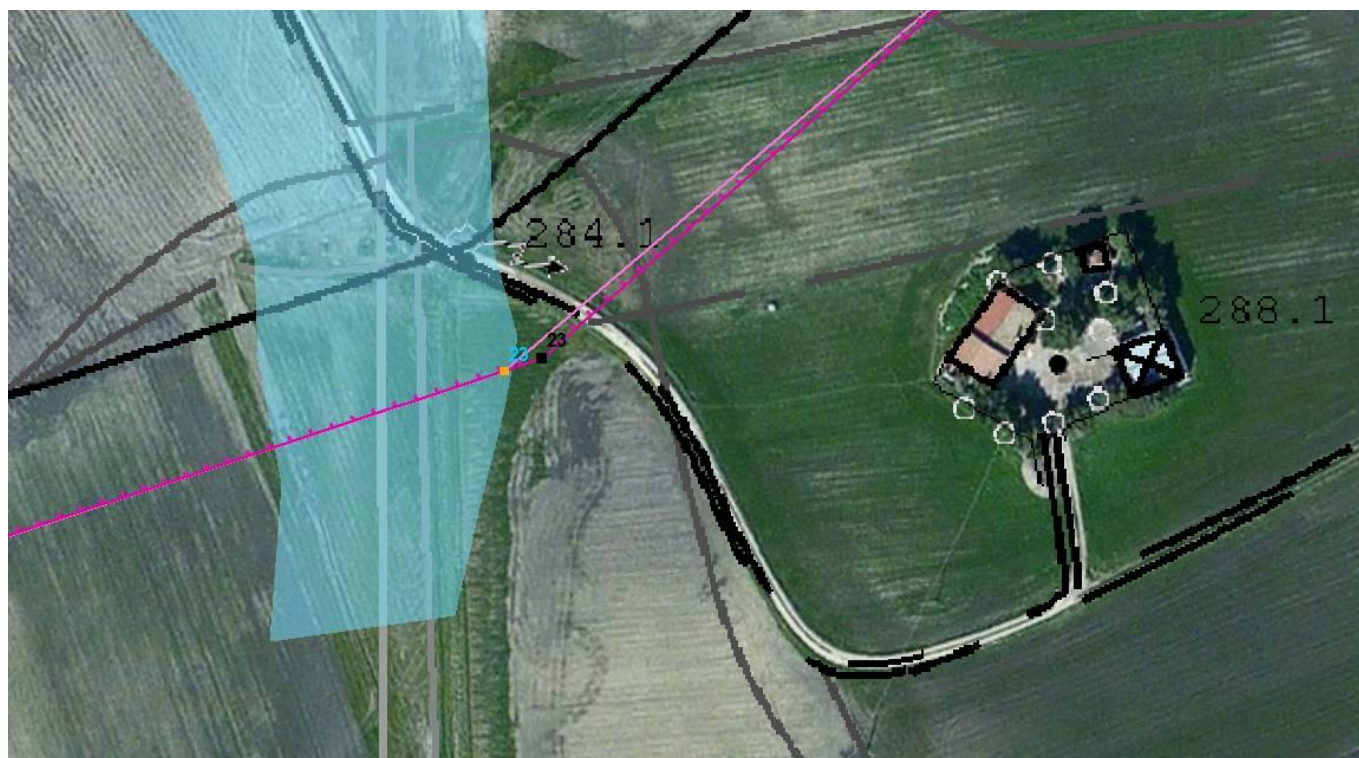
Figura 11 - il sostegno 23 è stato posizionato fuori dalle aree a media pericolosità idraulica Tr 200 anni
